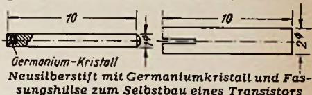
Germanium-Kristall Neusilberstift mit Germaniumkristall und Fasungshülse zum Selbstbau eines Transistors
